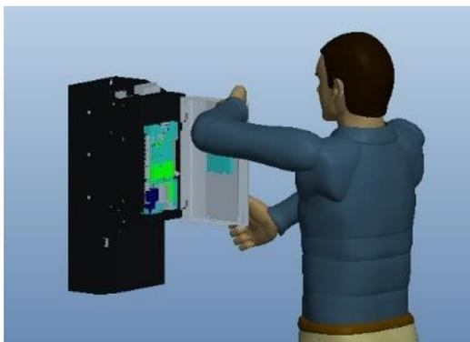
4): 待连接完控制线束和一些插卡的线束后，按相反的顺序将上盖归位。
